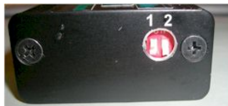
Abbildung 5 DIP-Schalter und Zündkurvenauswahl.
