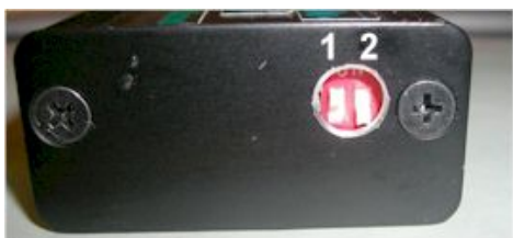
Abbildung 4 DIP-Schalter und Zündkurvenauswahl.
