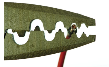
Crimpen mit einer Crimpzange.
