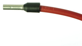
Die Aderendhülse wird soweit es geht auf das Kabel aufgeschoben.
