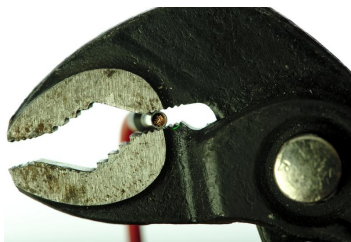
Crimpen mit einer Wasserpumpenzange.
