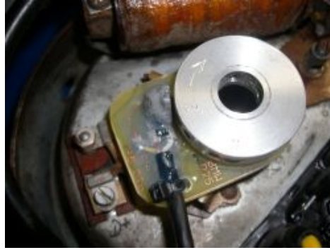
Die Rotormittelschraube entfernen und durch die mitgelieferte Inbusschraube und dem Mitnehmer ersetzen. Zuletzt wird der Magnetring auf den Mitnehmer aufgeschoben, aber die Madenschrauben noch nicht festziehen.
