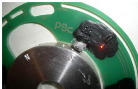
Abbildung 8 Die LED geht an wenn der S-Magnet am Sensor vorbeiläuft.
