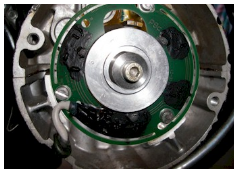
Abbildung 2.d Pickup, Mitnehmer und Magnetring montiert.
