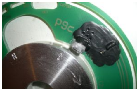
Abbildung 8.a Der Magnetring wird so positioniert daß der S-Magnet kurz vor dem Sensor steht.
