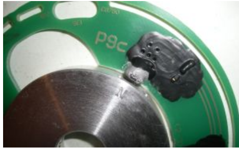
Abbildung 8.d Die LED geht aus wenn der N-Magnet am Sensor vorbeiläuft.
