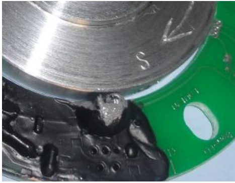
Abbildung 8 Die LED geht aus wenn der N-Magnet am Sensor vorbeiläuft.
