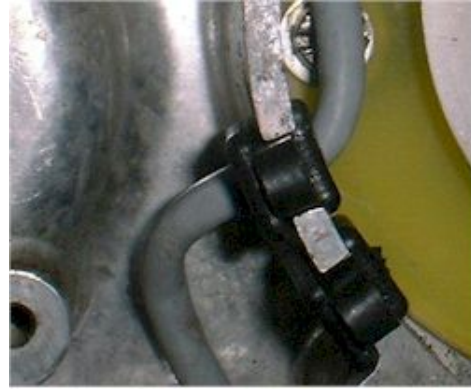
Abbildung 2 Das Anschlußkabel wird mit Hilfe der mitgelieferten Gummitülle durch das Motorgehäuse geleitet.
