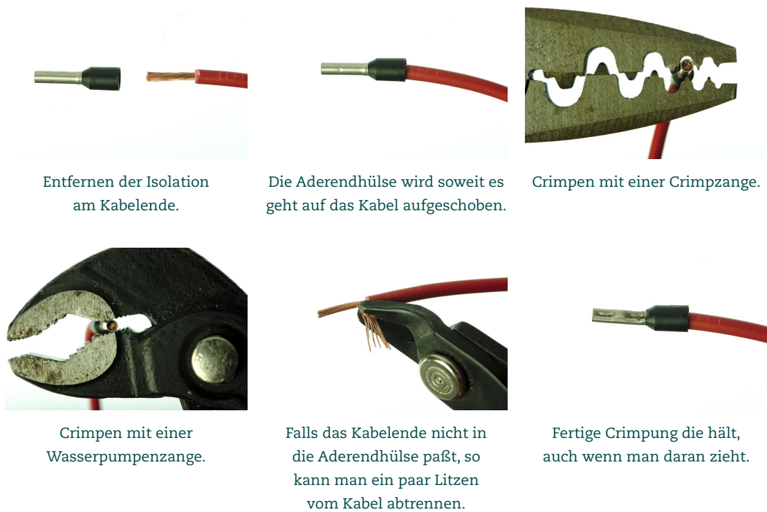
Abbildung 3 Crimpen der Aderendhülsen
