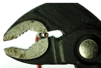
Crimpen mit einer Wasserpumpenzange.
