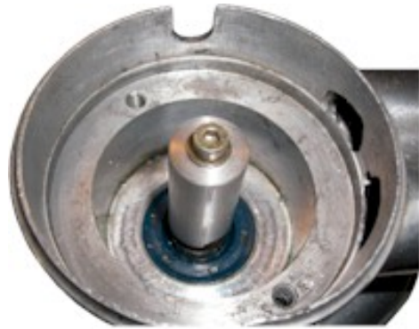
Abbildung 2 Montage des Mitnehmers auf der Welle.
