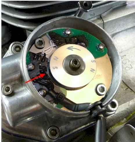
Abbildung 7 Dieser Sensor wird für die Grundeinstellung benutzt.
