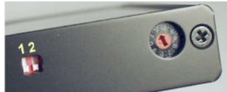
Abbildung 4 DIP-Schalter und Drehschalter.
