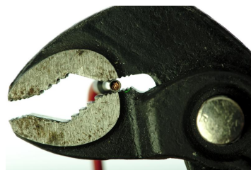
Crimpen mit einer Wasserpumpenzange.
