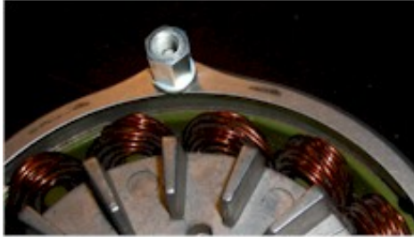
Abbildung 2 Gewindestange mit Sechskant.
