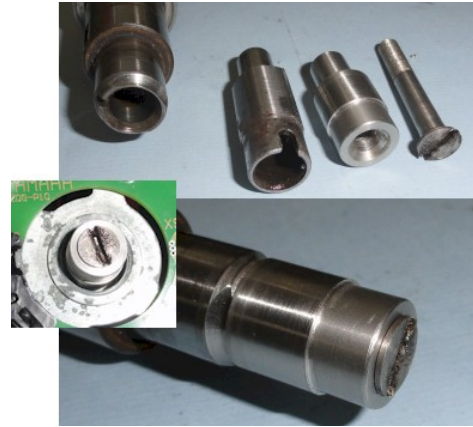
Abbildung 2 Montage des Mitnehmers auf einer Welle mit abnehmbarem Nocken.
