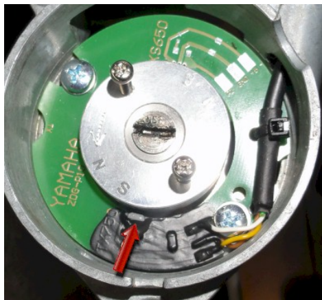
Abbildung 6 Dieser Sensor wird für die Grundeinstellung verwendet.
