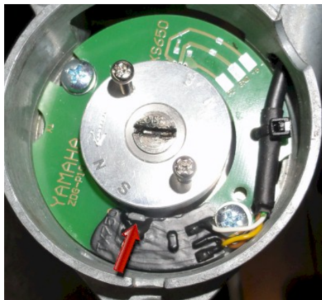
Abbildung 6 Dieser Sensor wird für die Grundeinstellung verwendet.
