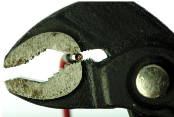
Crimpen mit einer Wasserpumpenzange.
