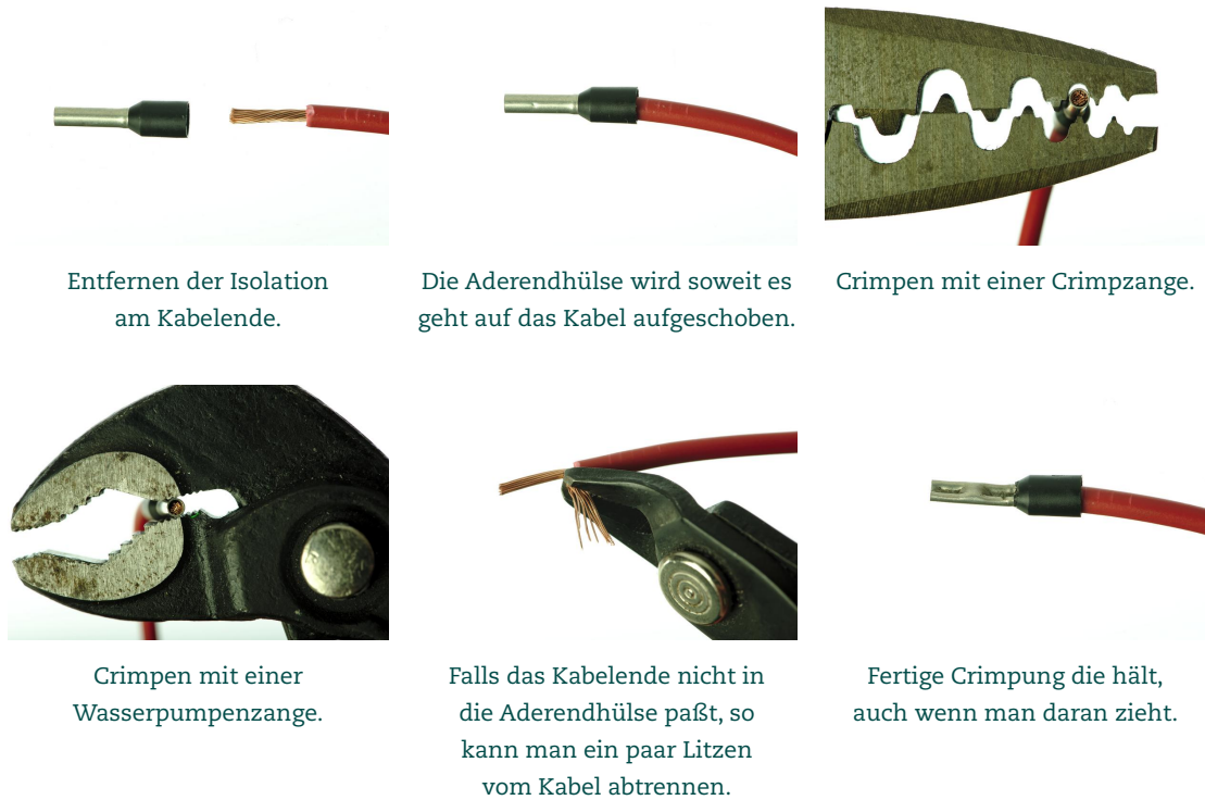
Abbildung 2 Crimpen der Aderendhülsen
