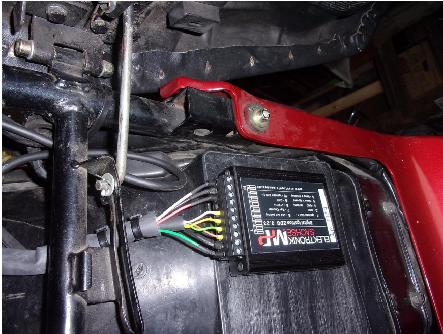
Abbildung 3 Zündbox montiert unter dem Sitz.
