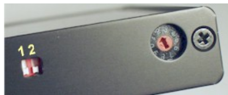
Abbildung 9 DIP-Schalter und Drehschalter.
