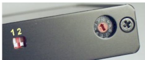
Abbildung 4 DIP-Schalter und Drehschalter.
