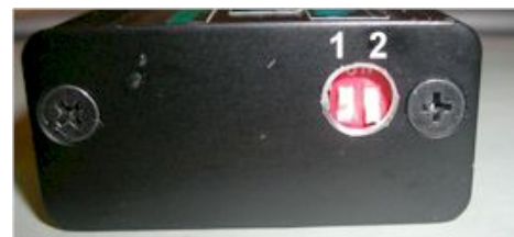
Abbildung 4 DIP-Schalter und Zündkurvenauswahl.
