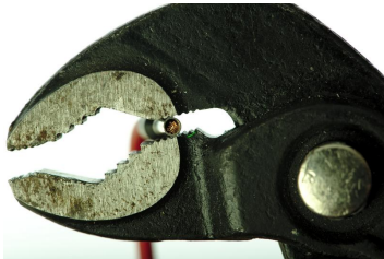
Crimpen mit einer Wasserpumpenzange.
