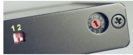
Abbildung 4 DIP-Schalter und Drehschalter.
