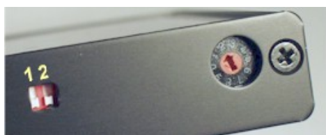
Abbildung 5 DIP-Schalter und Drehschalter.
