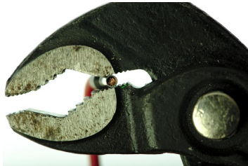
Crimpen mit einer Wasserpumpenzange.
