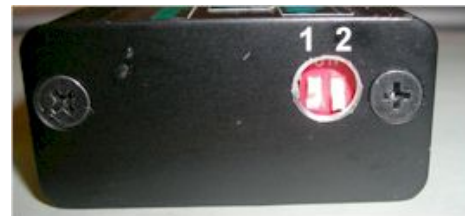
Abbildung 4 DIP-Schalter und Zündkurvenauswahl.
