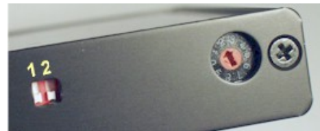
Abbildung 4 DIP-Schalter und Drehschalter.
