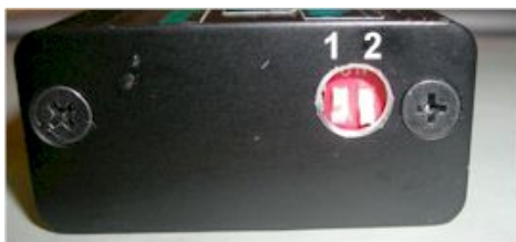
Abbildung 4 DIP-Schalter und Zündkurvenauswahl.
