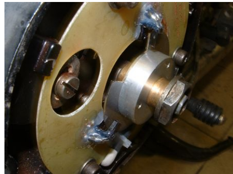
Abbildung 2.e Ausrichtung von Magnetring zu Pickup (Bild zeigt ältere Version als ausgeliefert).
