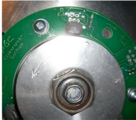
Abbildung 8.a Beim Vorbeilaufen des N-Magnetes geht die LED aus.
