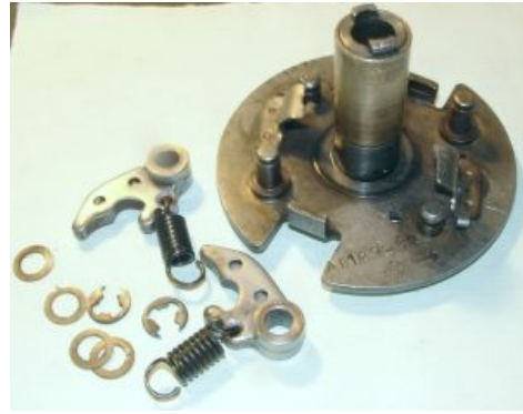
Abbildung 2.b Demontage des alten Fliehkraftreglers.
