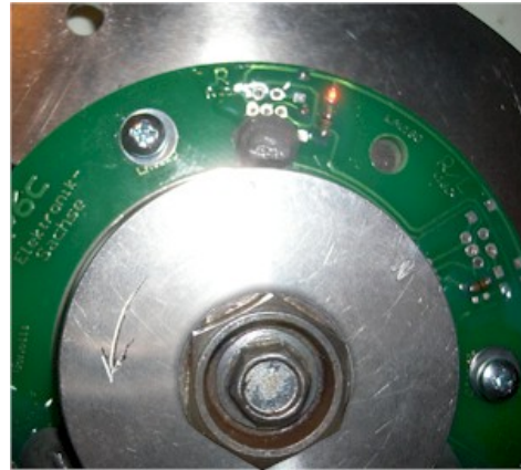
Abbildung 8.b Beim Vorbeilaufen des S-Magnetes geht die LED an.
