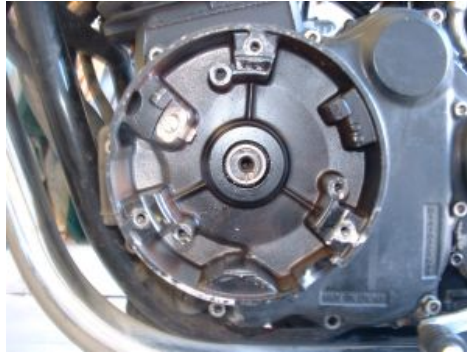
Abbildung 2.a Demontage der alten Zündung.
