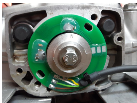
Pickup mit montiertem Mitnehmer und Magnetring. Die M5-Schrauben mit denen das Pickup befestigt wird, wurden hier noch nicht eingeschraubt.
