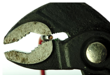
Crimpen mit einer Wasserpumpenzange.
