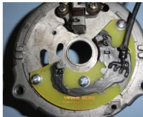
Montage der Sensorplatte auf der Alu-Lichtmaschine
