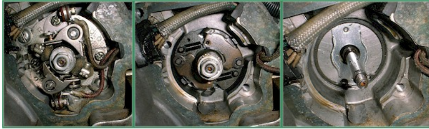
Abbildung 2 Demontage der alten Zündungskomponenten.
