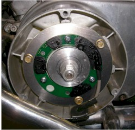
Abbildung 2 Komplette Montage von Pickup
