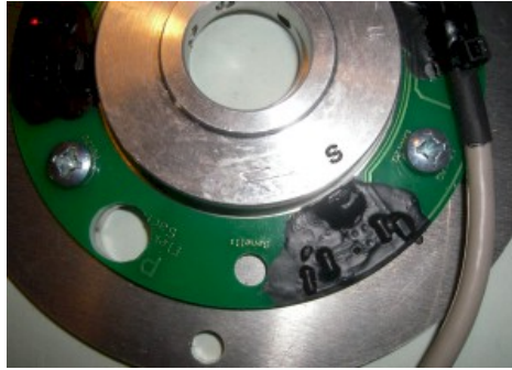
Abbildung 8 Die LED geht aus wenn der Kolben auf OT ist.
