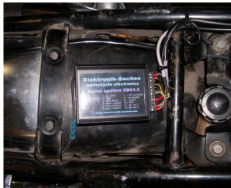
Abbildung 3 Montagevorschlag der Zündbox.
