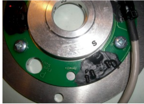
Abbildung 8.b Die LED geht aus wenn der Kolben auf OT ist.
