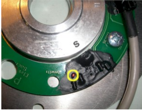
Abbildung 8.a Dieser Sensor wird für die Grundeinstellung benutzt.
