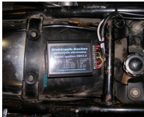
Abbildung 3 Montagevorschlag der Zündbox.
