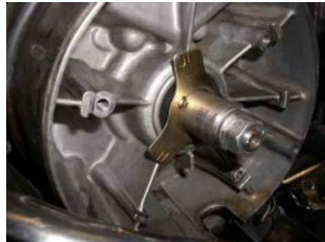
Abbildung 2 Entfernen der alten Zündungskomponenten.
