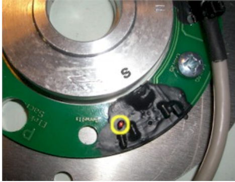
Abbildung 8 Dieser Sensor wird für die Grundeinstellung benutzt.
