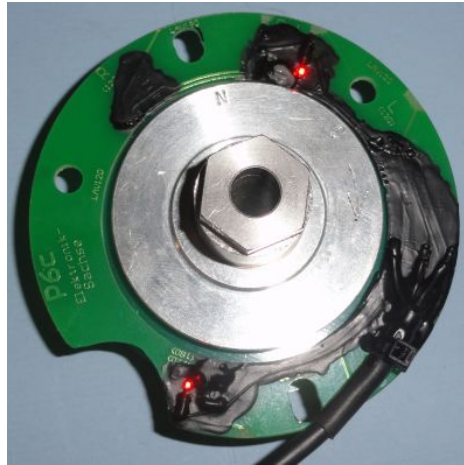
Abbildung 6 Pickup, Mitnehmer und Magnetring.
