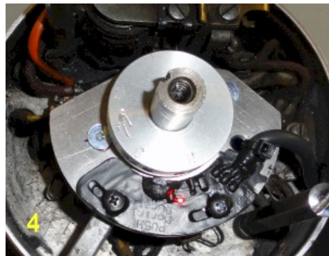
Abbildung 2.e Montage des Magnetrings auf der Welle.
