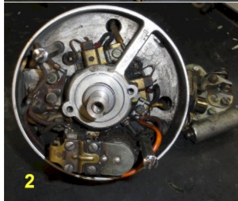
Abbildung 2.b Die Komponenten der alten Zündung werden entfernt.
