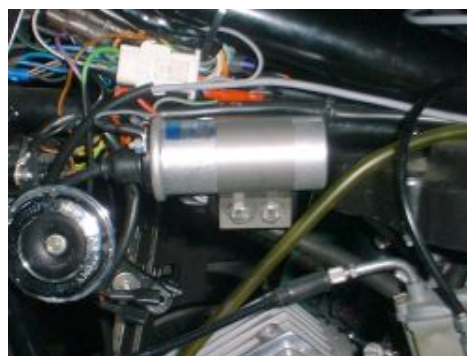
Abbildung 2 Montagevorschlag der Zündspulen PVL220.
