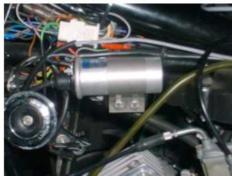
Abbildung 2.d Montagevorschlag der Zündspulen PVL220.
