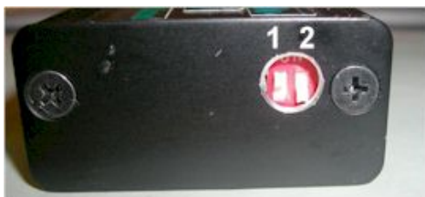
Abbildung 4 DIP-Schalter und Zündkurvenauswahl.
