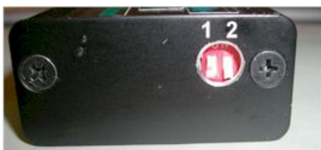
Abbildung 4 DIP-Schalter und Zündkurvenauswahl.
