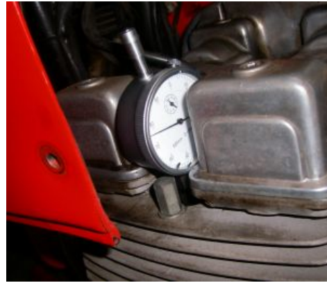
Abbildung 6 Meßuhr um den OT genau zu bestimmen.
