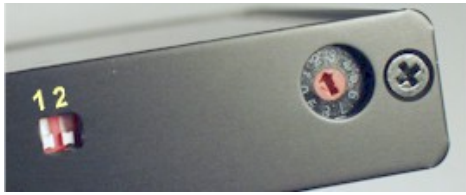
Abbildung 7 DIP-Schalter und Drehschalter.
