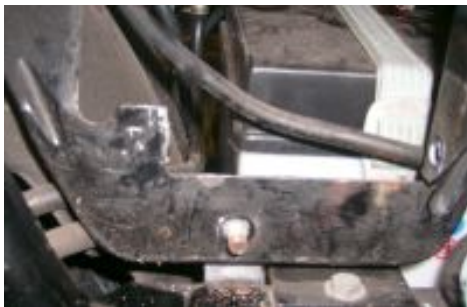
Abbildung 2 Montagevorschlag für die Zündbox.
