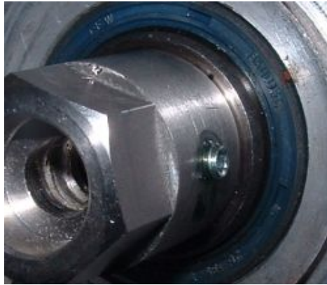
Abbildung 2 Die Madenschraube im Mitnehmer arretiert diesen in der Nut.
