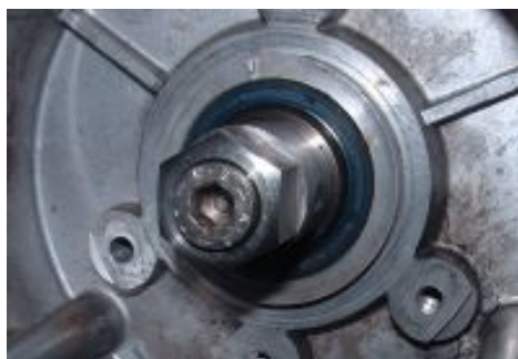
Abbildung 2.d Der Mitnehmer wird mittels Zentralschraube befestigt.
