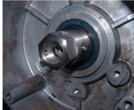
Abbildung 2 Montage des Mitnehmers. Die Madenschraube greift in die Nut.
