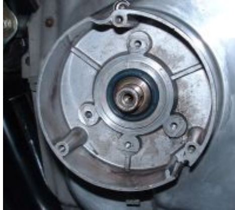
Abbildung 2 Entfernen der alten Zündungskomponenten.
