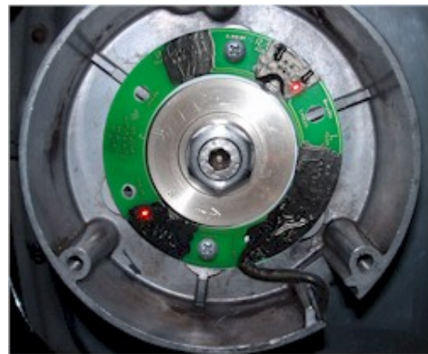
Abbildung 2 Komplette Montage von Pickup, Mitnehmer und Magnetring.
