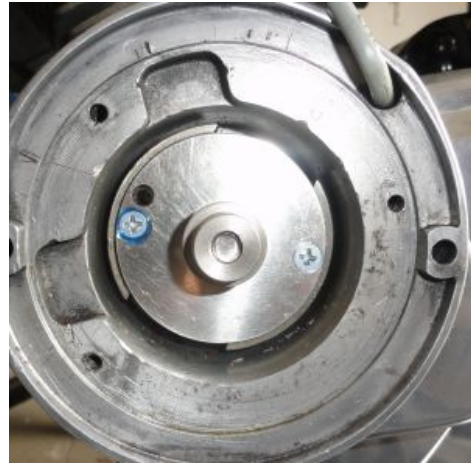
Abbildung 2.b Montage des Mitnehmers.
