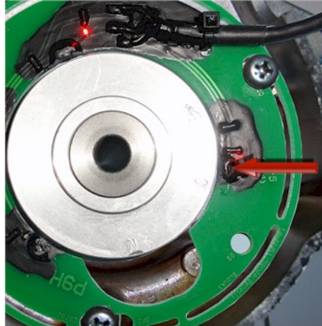
Abbildung 6 Dieser Sensor wird für die Grundeinstellung verwendet.
