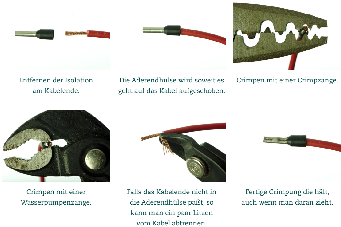
Abbildung 4 Crimpen der Aderendhülsen
