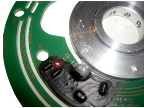
Abbildung 6 Die LED geht an wenn der S-Magnet am Sensor vorbeiläuft und aus wenn der N-Magnet am Sensor vorbeiläuft.
