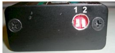
Abbildung 4 DIP-Schalter und Zündkurvenauswahl.
