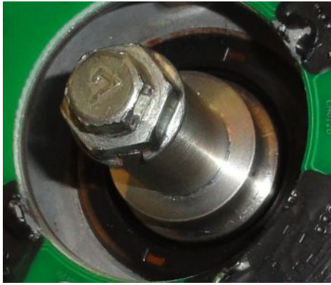
Abbildung 2.d Montage des Mitnehmers.
