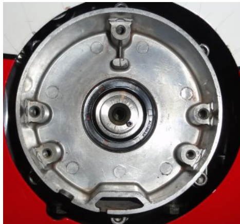
Abbildung 2 Entfernen der alten Zündung.
