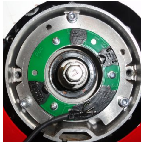
Abbildung 2.b Montage des neuen Pickup auf der Trägerplatte.
