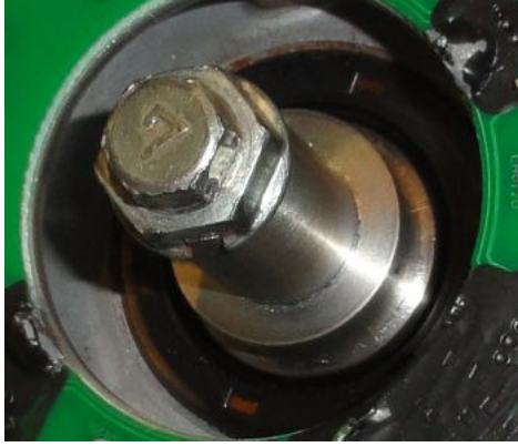
Abbildung 2 Montage des Mitnehmers.
