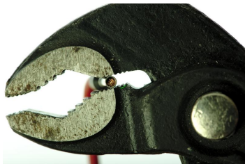
Crimpen mit einer Wasserpumpenzange.
