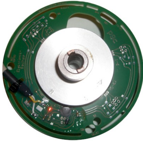
Abbildung 7 Pickup mit Mitnehmer und Magnetring.
