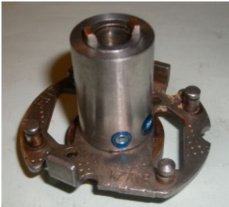
Abbildung 2 Mitnehmer montiert auf der Welle der Trägerplatte.
