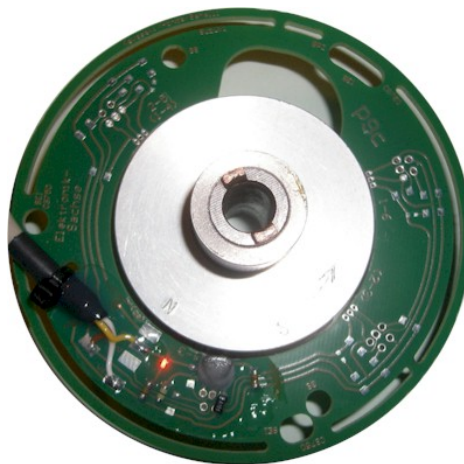
Abbildung 7 Pickup mit Mitnehmer und Magnetring.
