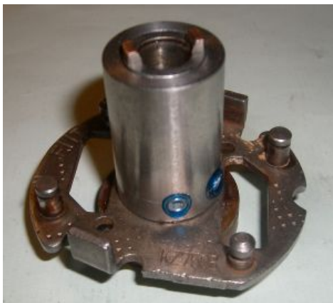
Abbildung 2 Mitnehmer montiert auf der Welle der Trägerplatte.
