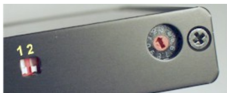
Abbildung 4 DIP-Schalter und Drehschalter.
