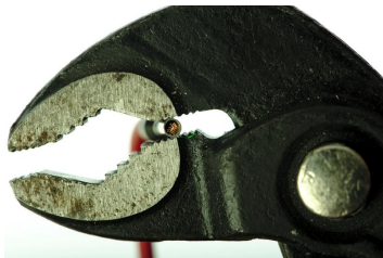
Crimpen mit einer Wasserpumpenzange.
