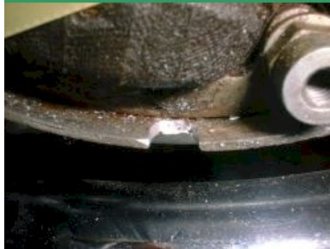
Abbildung 2.e Ausschnitt für das Pickupkabel.
