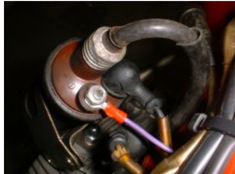
Abbildung 3.b Montagevorschlag der linken Zündspule.
