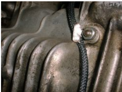
Abbildung 2 Schutz des Pickupkabels.
