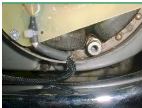
Abbildung 2.g Führen des Pickupkabels durch den Ausschnitt.
