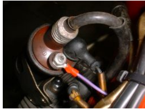
Abbildung 3 Montagevorschlag der linken Zündspule.
