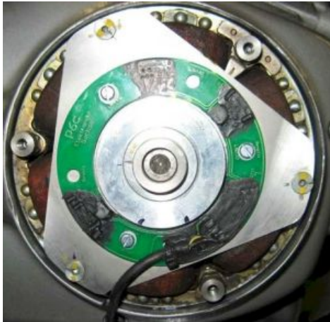
Abbildung 2 Montage des Pickups (das Bild zeigt eine ältere Version, die aktuelle sieht etwas anders aus).
