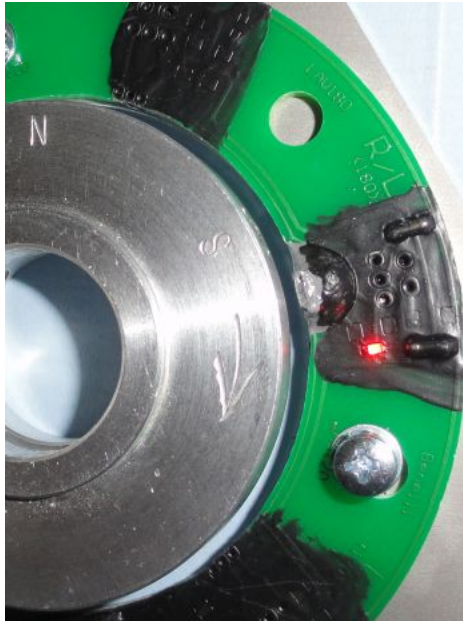
Abbildung 9 Dieser Sensor wird für die Grundeinstellung benutzt.
