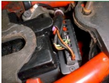
Abbildung 2 Vorschlag zur Montage der Zündbox.
