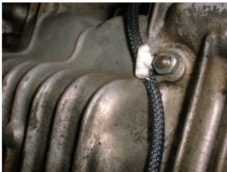
Abbildung 2.j Schutz des Pickupkabels.
