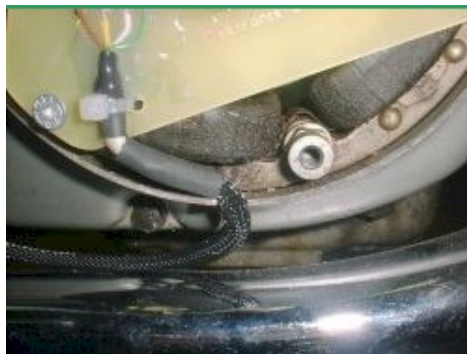
Abbildung 2 Führen des Pickupkabels durch den Ausschnitt.
