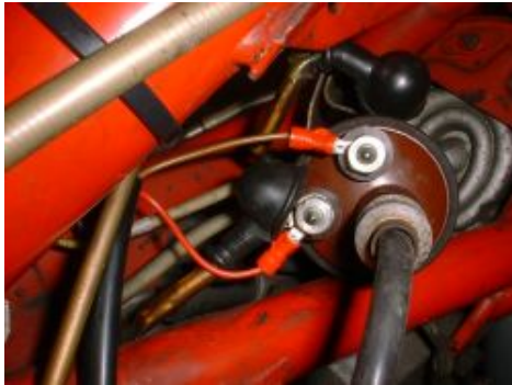
Abbildung 3.a Montagevorschlag der rechten Zündspule.
