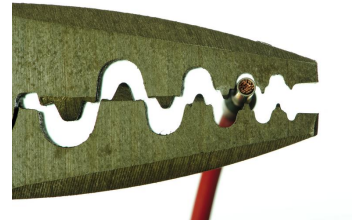
Crimpen mit einer Crimpzange.
