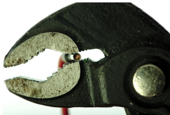
Crimpen mit einer Wasserpumpenzange.
