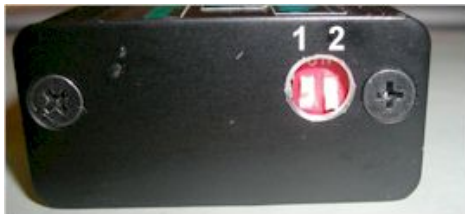
Abbildung 6 DIP-Schalter und Zündkurvenauswahl.
