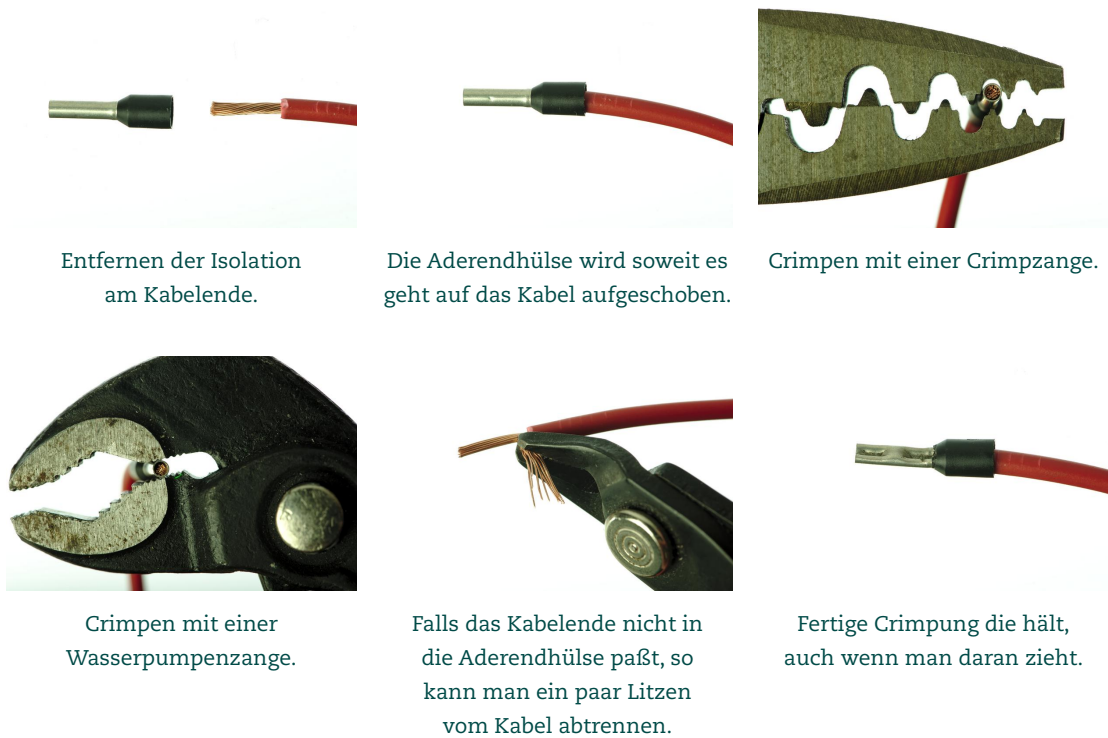
Abbildung 2 Crimpen der Aderendhülsen
