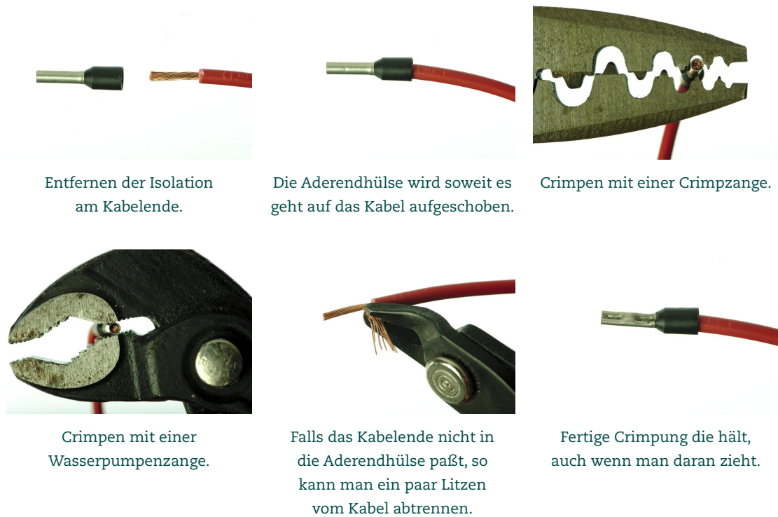
Abbildung 2 Crimpen der Aderendhülsen
